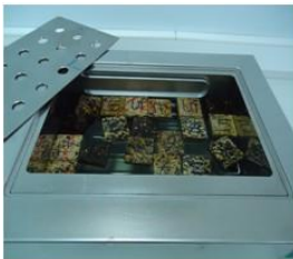
Şekil 1. Su içerisinde 24 saat bekletilen deney örnekleri
