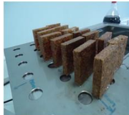
Şekil 1. Su içerisinde 24 saat bekletilen deney örnekleri
