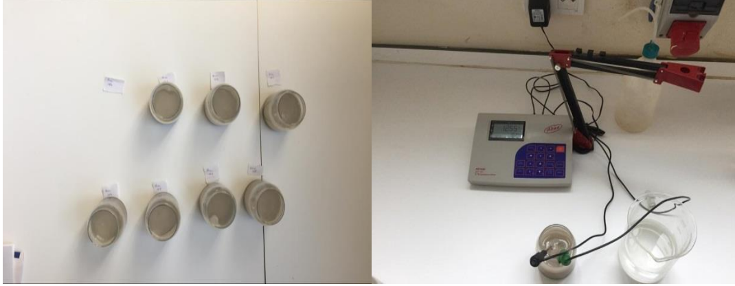
Şekil 4.6 : Hazırlanan solüsyonlar ve pH deney düzeneği
