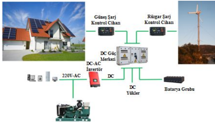
Şekil 4.3: Hibrit bağlantılı yenilenebilir enerji sistemi [68]
