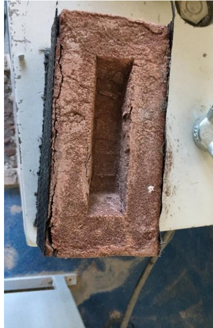
Resim 4.2. CFRPB02 numunesinin test sonrası durumu
