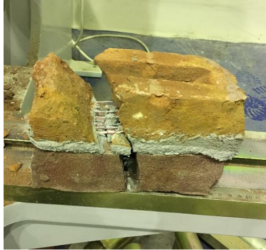
Resim 4.12. Murfor® yatay derz donatısıyla güçlendirilmiş numunenin 3-noktalı eğilme deneyi sonrası fiziki durumu
