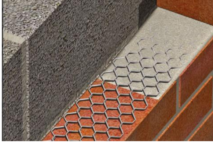
Şekil 2.6. Izgara tip yatay derz donatısı
