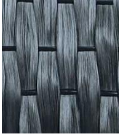
Resim 3.8. Tek yönlü CFRP kumaşın örgü detayı
