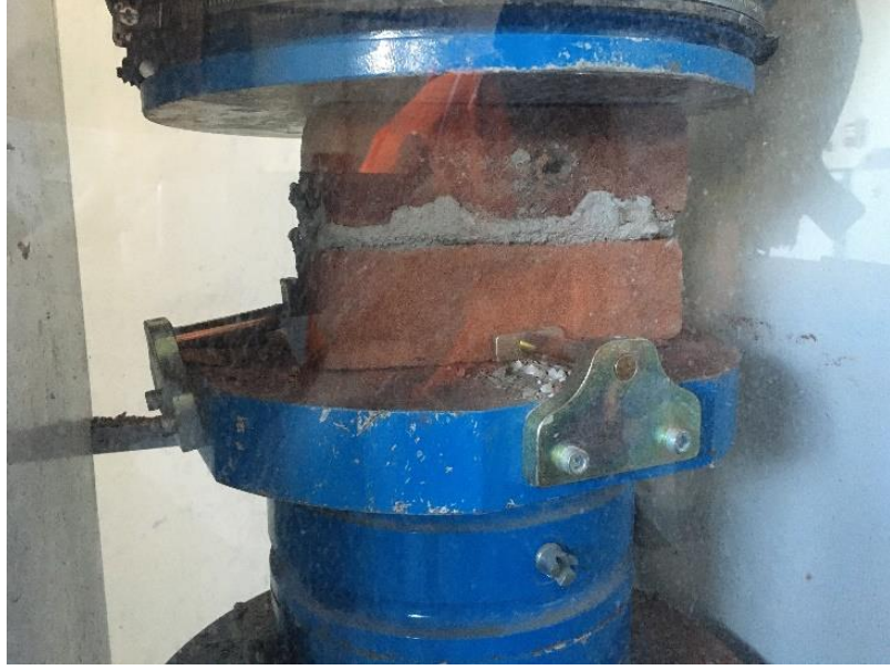
Resim 3.24. Murfor® ile güçlendirilmiş numunelerde basınç deneyinin gerçekleştirilmesi
