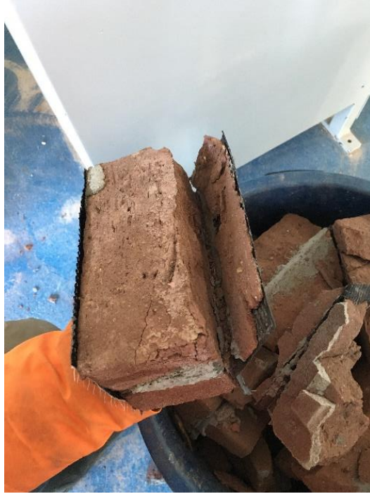
Resim 4.4. CFRPB04 numunesinin test sonrası durumu
