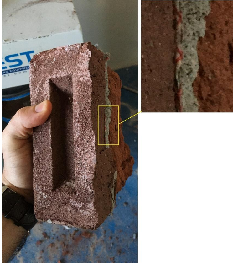
Resim 4.7. Basınç deneyi sonucunda yatay derz donatısı boyunca çizgisel bir şekilde devam eden çatlak görünümü
