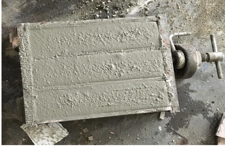
Resim 3.6. Harç malzemesinin 40x40x160 mm kalıba dökülmesi
