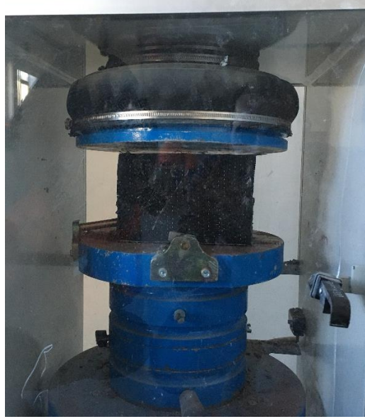
Resim 3.22. CFRP kumaş ile güçlendirilmiş numunelerde basınç deneyinin gerçekleştirilmesi
