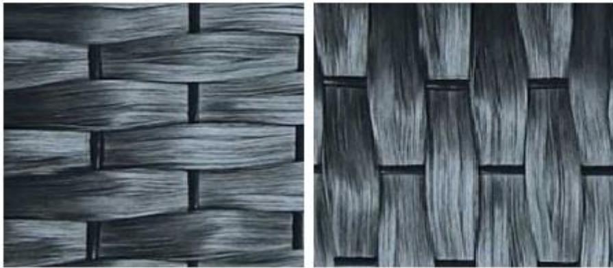
Resim 3.12. 2. seri numunelerin iki yan yüzeyine CFRP kumaşların farklı yönde uygulanması
