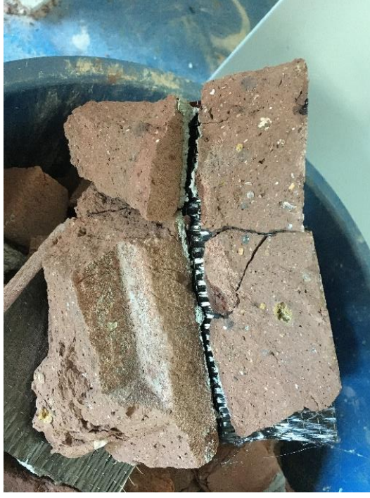
Resim 4.3. CFRPB03 numunesinin test sonrası durumu
