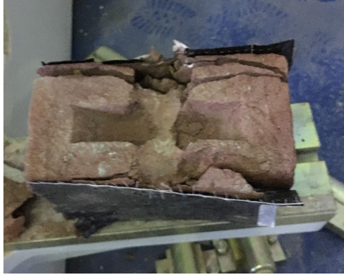
Resim 4.11. 3-noktalı eğilme deneyi sonrası, farklı doğrultuda yapıştırılmış olan CFRP kumaşın fiziki durumu
