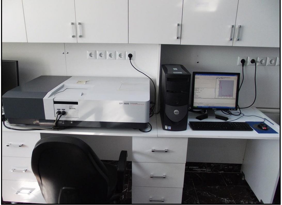
Şekil 3.3: Katkısız TiO 2 ve Fe katkılı TiO 2 ince filmlerin U-V ölçümleri için kullanılan UV-VIS spektrofotometre cihazı.
