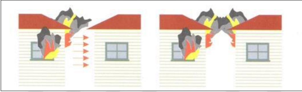
Resim 3.4. Işınım yolu ile ısı transferi (Kırtaş, 2017)
