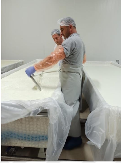
Resim 4.6 Teleme kırma işlemi
