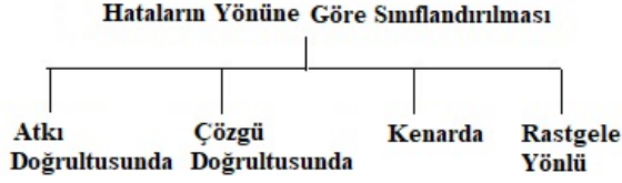
Şekil 5. Dokuma kumaş hatalarının yönüne göre sınıflandırılması
