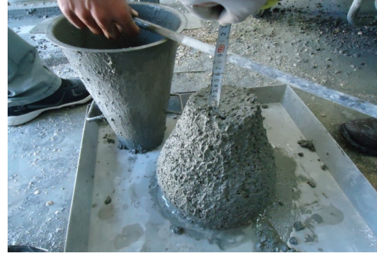
Şekil 2.6. Çökme değerinin belirlenmesi
