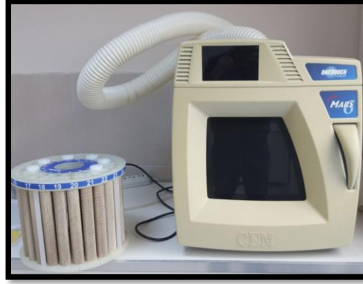
Şekil 4.4 : Örneklerin çözünürleştirilmesi için kullanılan mikrodalga fırın (orjinal).
