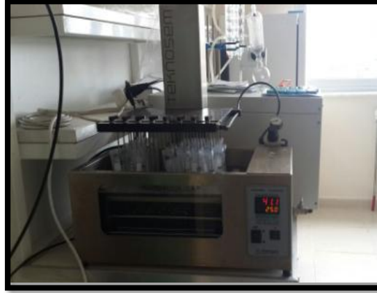
Şekil 4.5 : Evaporator ile örnekleri hazırlama aşaması (orijinal).
