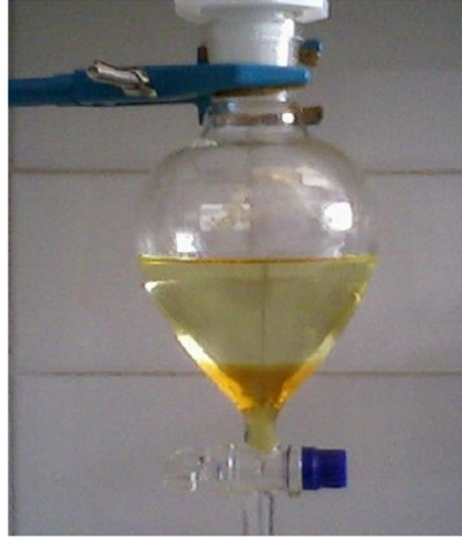
Şekil 3.4: Ayırma hunisiyle biyodizel-gliserin ayrımı.
