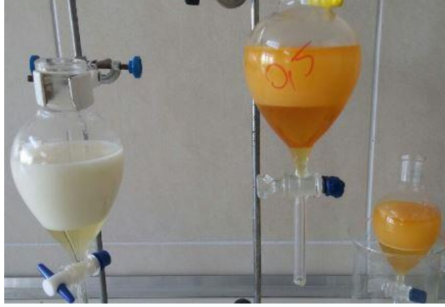
Şekil 3.6: Saf su ile yıkanan biyodizelin ayrımı.
