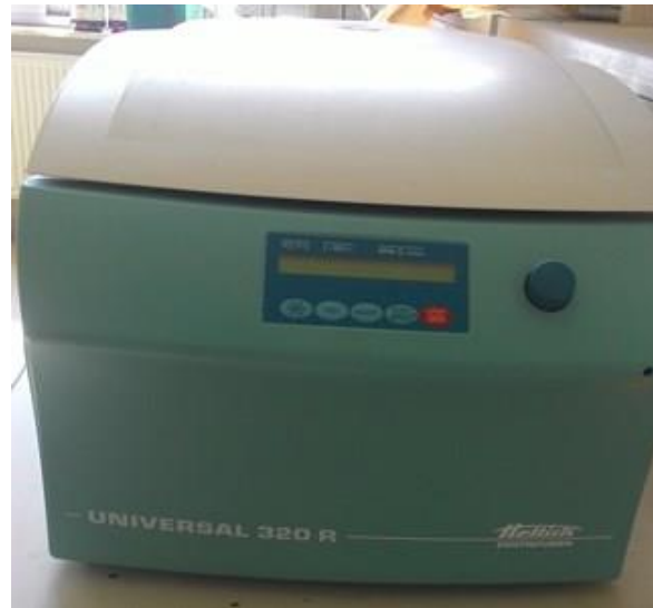
Şekil 3.5: Hettich Universal 320 R santrifüj cihazı.
