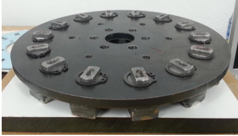
Şekil 5.7 : Eksen döndürme parçalarının yerleştirildiği rotor kalıbı.
